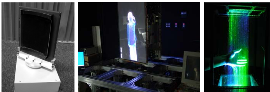
図2 (左：視点の方向によって異なる映像を表示するディスプレイの試作機、中：等身大の人物像を多視点で表示することを狙うプロトタイプ、右：水滴による光の拡散と目の残像を利用して空間に立体的な映像を表示する空間充填型ディスプレイ)
